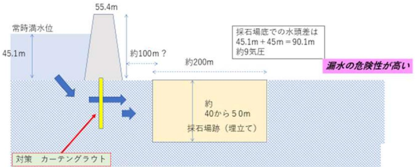
※ 埋立凹地は極めて透水性が高いので、ダム底からの水みちの形成、漏水の可能性がある。
