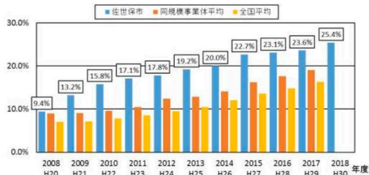
管路(水道管)の経年化率
